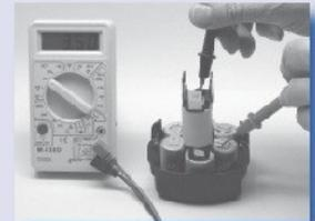
Die Leistungsfähigkeit des Akkus wird genau ausgemessen.
