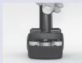
Jetzt ist der Akku fertig und das Gehäuse kann geschlossen werden. Der Kunde erhält einen elektrisch absolut neuwertigen Akku. Lediglich das gebrauchte Gehäuse und die Sicherungselemente sind gebraucht.
