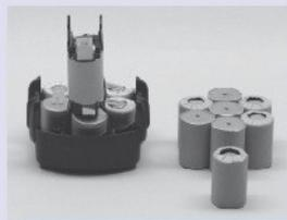
Wenn der Akku als defekt erkannt wurde, wird das Gehäuse geöffnet. Aus einzelnen Zellen bauen wir den Akkublock genau dem defekten Muster nach. Unser Kunde kann die Zellenkapazität vorher auswählen. Die Zellen werden in eine Papphülse gesteckt und verklebt.
