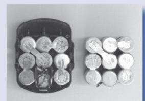
Der neue Akkublock wird in das gebrauchte Gehäuse eingesetzt und die Anschlussbleche werden angelötet.
