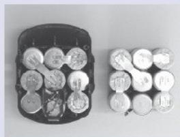
Nach dem Verschweißen der Zellen wird der neue Akkublock in das gebrauchte Gehäuse eingesetzt und die Anschlussbleche werden angelötet. Hierbei findet auch nochmals eine Kontrolle der eingebauten Schutzelemente wie Thermo-switch, Pepi oder temperaturabhängiger Widerstände statt.
