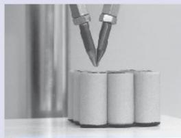
Die elektronischen Verbindungen der einzelnen Zellen werden mit einer speziellen Punktschweißmaschine hergestellt. Hierbei ist wichtig, dass auf jedem Pol der Zellen eine möglichst große Anzahl von Schweißpunkten aufgebracht wird. Außerdem verwenden wir nur Schweißband mit einem hohen Querschnitt. Der große Querschnitt der Verbindungen und die hohe Anzahl der Schweißpunkte ergibt niedrige Innenwiderstände, und somit eine hohe Leistungsabgabe.
