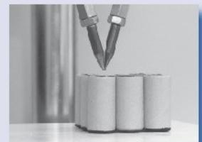
Die elektronischen Verbindungen der einzelnen Zellen werden mit einer speziellen Punktschweißmaschine hergestellt.
