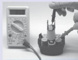
Mit verschiedenen Messgeräten wird der Akku durchgemessen. In unserem Bild wird zunächst die Spannung ohne Last gemessen. Mit einem speziellen Messgerät wird der Akku anschließend unter Last gemessen. Lässt sich aus diesen zwei Parametern keine 100%ige Aussage über die Leistungsfähigkeit treffen, wird der Akku an unserer EDV überwacht und prozessorgesteuertes Ladegerät angeschlossen. Das Messgerät protokolliert genau das Lade- und Entladeverhalten und wertet die Ergebnisse graphisch aus.
