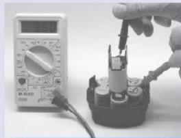
Mit verschiedenen Messgeräten wird der Akku durchgemessen. In unserem Bild wird zunächst die Spannung ohne Last gemessen. Mit einem speziellen Messgerät wird der Akku anschließend unter Last gemessen. Lässt sich aus diesen zwei Parametern keine 100%ige Aussage über die Leistungsfähigkeit treffen, wird der Akku an unserer EDV überwachten und prozessorgesteuertes Ladegerät angeschlossen. Das Messgerät protokolliert genau das Lade- und Entladeverhalten und wertet die Ergebnisse graphisch aus.
